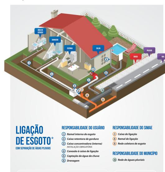
A rede coletora interna de esgoto compreende as tubulações (1) que estão dentro do terreno, incluindo caixa retentora de gordura 2 e caixa concentradora (obrigatória) 3. A interligação do sistema interno ao sistema público de esgoto será executada por uma ÚNICA TUBULAÇÃO (4)
